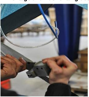
Vorzugsweise demontieren Sie den Kopfblock Ihrer Säge, damit Sie es einfacher haben, die zwei Gewinde für die Montage der Anlage zu schneiden. Verwenden Sie Schraubensicherung (z.B. Loctite) um einen sicheren Sitz der Schrauben zu gewährleisten.
